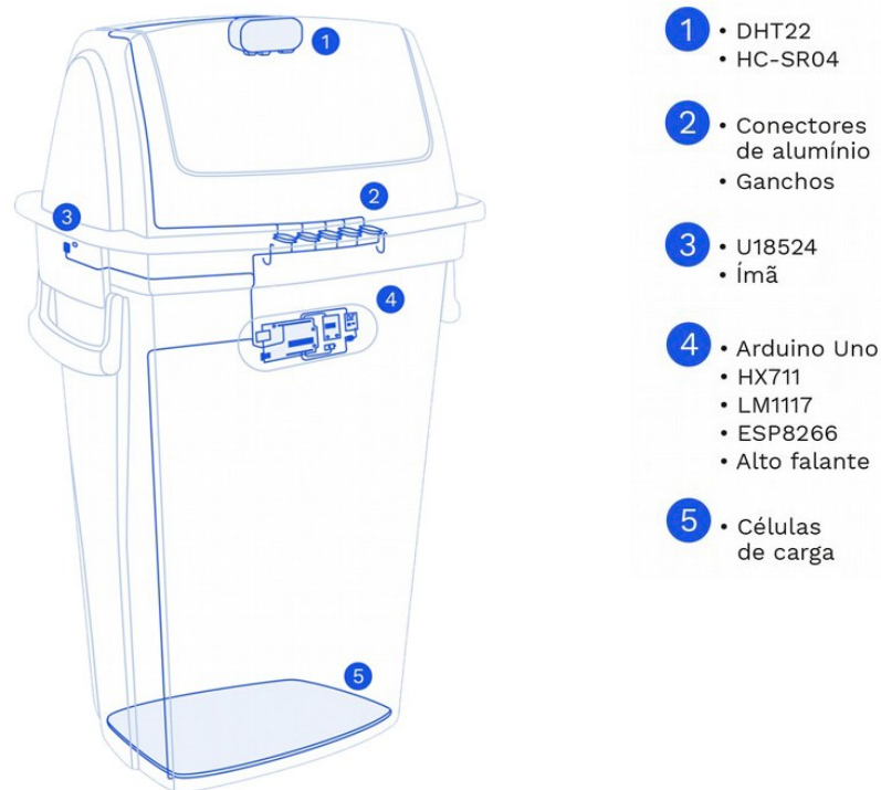
Figura 1: Componentes do protótipo da lixeira inteligente
